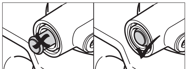
[48] A Mauvais montage [49] B O.K. Téton de contrôle en cas d'attelage fermé
